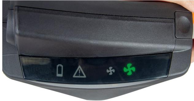
**6.4** Durch erneutes Drücken schaltet das Gebläse in den Vollastbetrieb mit mind. 225 l/min; es leuchtet das größere grüne Gebläsesymbol auf. Durch erneutes Drücken des Schalters wechselt das Gebläse wieder in den Normalbetrieb.
