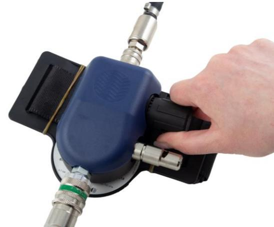
**1.6** Einstellrad am Regelventil gegen den Uhrzeigersinn bis zum Anschlag drehen, um die Luftmenge auf ein Minimum zu drosseln.
