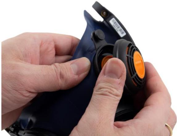
**14.1** Die Ausatemsmembrane sitzen an einem festen Zapfen innerhalb der Ventilklappen an beiden Seiten der Außenmaske. Die Klappen sind gleichzeitig mit der Membran zu ersetzen. Ventilklappen von den Ventilsitzen abziehen.
