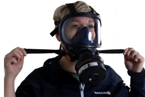
Gummibänder paarweise spannen, indem Sie die freien Bandenden nach hinten ziehen.
