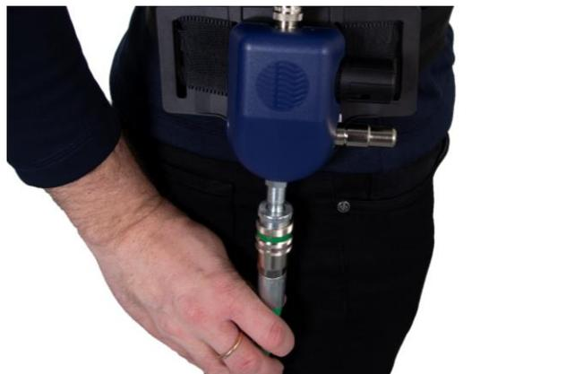
**9.2** Atemschlauch vom Regelventil lösen.
