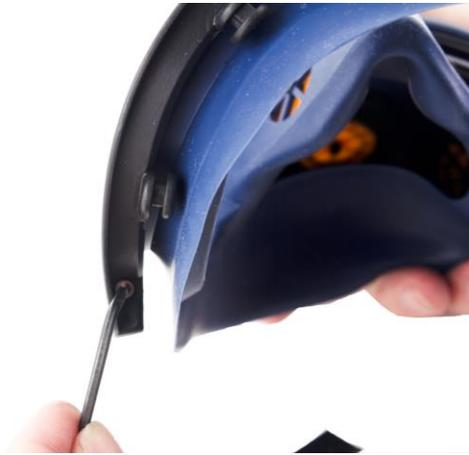
**12.1** Das Visier ist in einer Nut befestigt, die um die Visieröffnung der Außenmaske herum läuft und wird von einer oberen und einer unteren Rahmenhälfte gehalten. Die beiden Schrauben, mit denen die beiden Rahmenhälften miteinander verbunden sind, mit Hilfe eines 2,5 mm Innensechskantschlüssels lösen.
