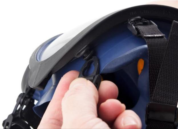
**15.1** Das Kopfgestell ist als Ersatzteil nur in kompletter Ausführung verfügbar. Bandhalterungen des Kopfgestells von den Bandhaltepunkten der Maske abziehen.
