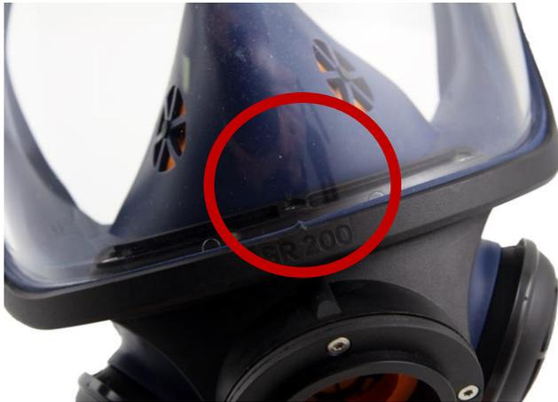
**12.4** Visier, Rahmenhälften und Maske haben eine Kennzeichnung, um die Mitte zu markieren. Das neue Visier so in die Nut einsetzen, dass die Mittelmarkierungen zusammenfallen. Um die Montage zu erleichtern, empfiehlt es sich, die Nut mit Seifenlösung o. dgl. anzufeuchten.
