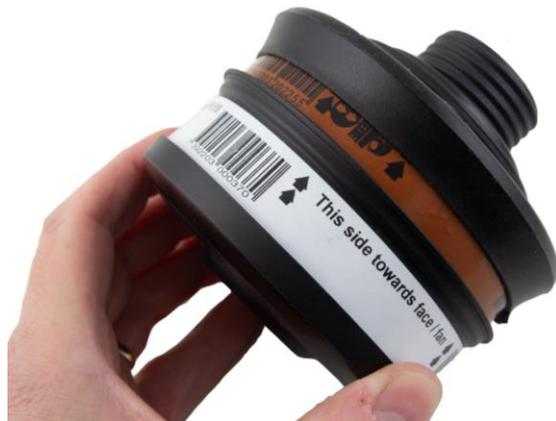
**3.2** Filter/Kombinationsfilter so in die Filteradapter einsetzen, dass die Pfeile auf dem Filter zum Gesicht hin zeigen. Achten Sie unbedingt darauf, dass der Filter rundum in der Innennut der Filterfassung zum Liegen kommt.
