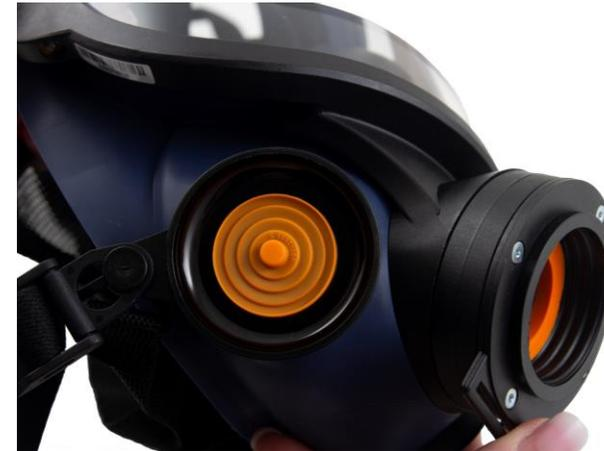
**1.2** Prüfen Sie insbesondere die Ein- und Ausatemmembrane und deren Sitz. Die Membrane ist ein Verbrauchsartikel und ist bei geringsten Anzeichen von Schäden oder Alterung zu ersetzen. Prüfen Sie den Zustand des Kopfgestells. Das Kopfgestell ist ein Verbrauchsartikel und ist bei geringsten Anzeichen von Verschleiß oder reduzierter Elastizität zu ersetzen.
