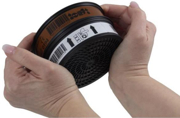
**3.1** Bei Vorhandensein von Gasen und Partikeln wie beim Spritzen von Lack sind Gas- und Partikelfilter in Kombination zu verwenden. Legen Sie den Partikelfilter auf die Oberseite der Patrone. Nehmen Sie die beiden Schutzelemente zur Hand. Drücken Sie fest, bis Sie hören, dass der Partikelfilter in den Gasfilter eingeschnappt ist.
