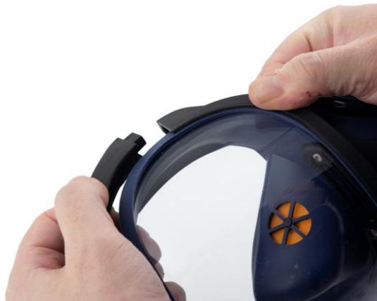
**12.2** Obere Rahmenhälfte vorsichtig abziehen. Den oberen Teil der Maske vorsichtig vom Visier herunterkrempeln und das Visier aus der unteren Nut herausheben. Reinigen Sie bei dieser Gelegenheit die Nut.
