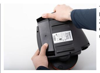
1.2 Heben Sie die Batterieabdeckung einige Zentimeter an, schieben Sie die Batterie mit dem Daumen und ziehen Sie sie heraus.
