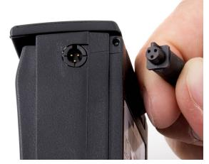
**2.2** Stellen Sie sicher, dass der Stift am Stecker des Kabels in der Nut der Batterie sitzt.
