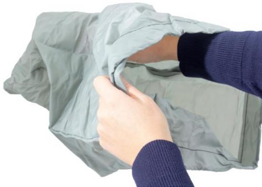
**1.5** Die Strömungsmesstüte umstülpen, so dass das durchsichtige Messrohr außen zu liegen kommt.
