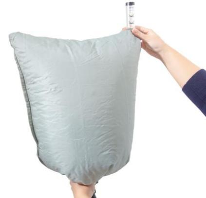
**1.6** Gesichtsteil in die Strömungsmesstüte einsetzen und Gebläse einschalten. Die Tüte im unteren Bereich um den Schlauch herum dicht umfassen.
