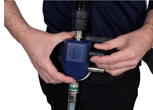
**2.7** Luftströmung mit Rad am Regelventil auf die entsprechende Arbeitsbelastung einstellen, siehe. In geschlossener Position (gegen den Uhrzeigersinn drehen) beträgt der Luftstrom ca. 175 l/Min, in geöffneter Lage (im Uhrzeigersinn drehen) ca. 260 l/Min.
