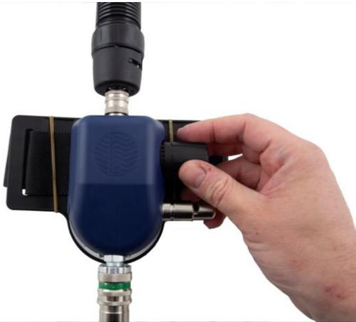
**1.4** Das Einstellrad des Regelventils gegen den Uhrzeigersinn bis zum Anschlag drehen, um den Luftstrom auf das Mindestniveau zu reduzieren.
